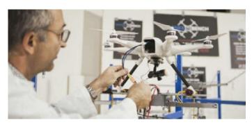
direttamente sul banco in totale sicurezza. La prova audiometrica fatta con il misuratore ad 1 metro a 45° in basso rispetto al drone, sotto un'elica fornisce una misura di 89db al decollo e 90 alla massima potenza.
